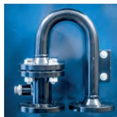
油泥管線中配置的自動清洗濾器
