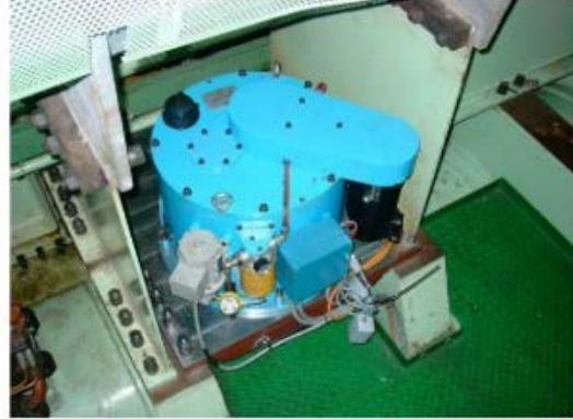
主機轉速檢測系統: (Main engine RPM detection system)
